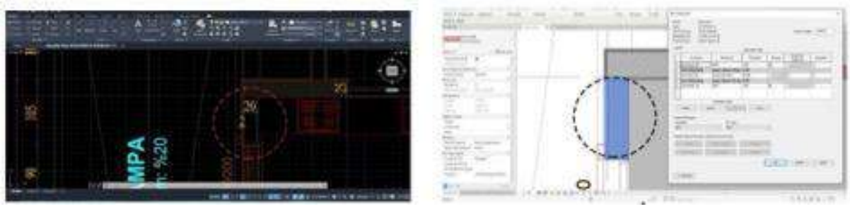
Şekil 9. (a) Revit modelinde bağımsız olarak tanımlanan 3 cm kalınlığındaki dış sıva katmanı, (b) Aynı katmanın AutoCAD çiziminde duvarla olan ilişkisinin gösterimi
