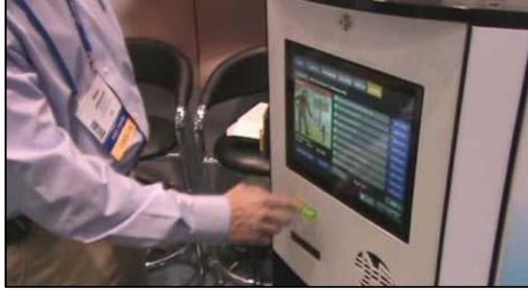
Şekil 3.5 Gerilimölçer teknoloji ile çalışan bir dokunmatik ekran. (Teknoloji-Rehberim, 2010)
