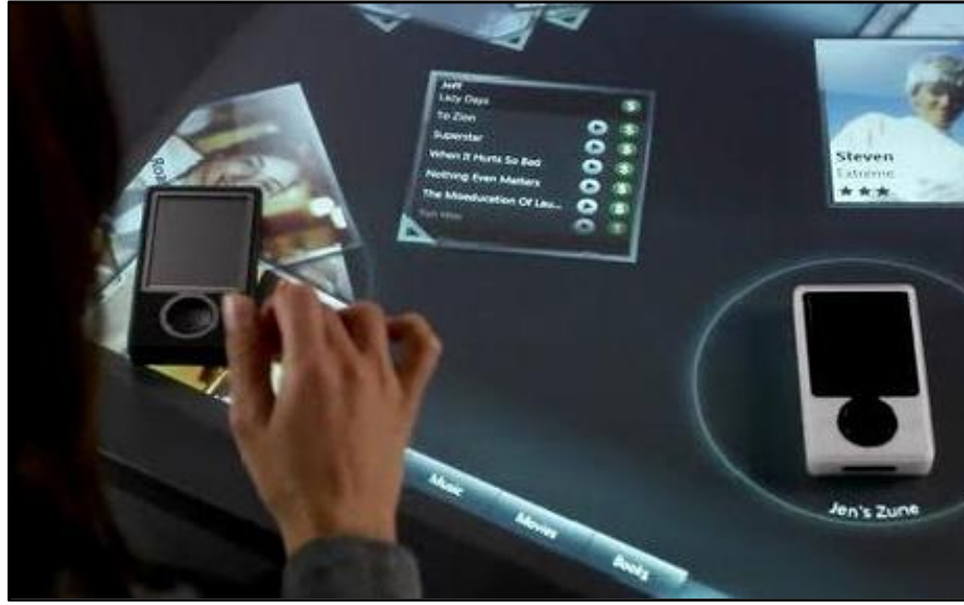
Şekil 3.22 Microsoft Surface ekranının üzerine konulan akıllı telefon gibi cihazlarla wifi vb kablosuz bağlantılarla iletişim kurabilmektedir. (Microsoft, 2011)
